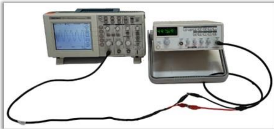
Figura 3.1.- Conexión Osciloscopio - Generador de Funciones
