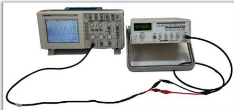
Figura 2.1.- Conexión Osciloscopio - Generador de Funciones Fuente: Claustro de Teoría Electromagnética
