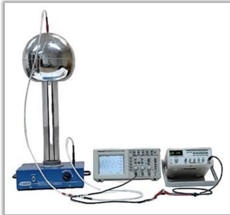
Figura 2.2.- Conexión Generador Van De Graaff - Osciloscopio - Generador de Funciones Fuente: Claustro de Teoría Electromagnética
