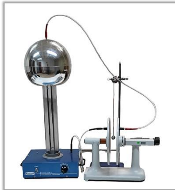
Figura 1.2.- Conexión Generador Van De Graaff – Capacitor de placas circulares
