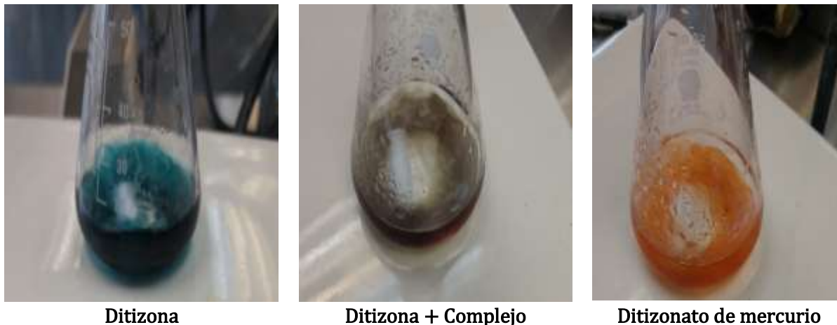
Figura 5. Fotografías obtenidas durante la determinación de mercurio en una muestra de sulfato ferroso (Caballero, 2024)
