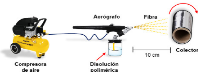
Fig. 2. Esquema del procedimiento para fabricar las fibras.
