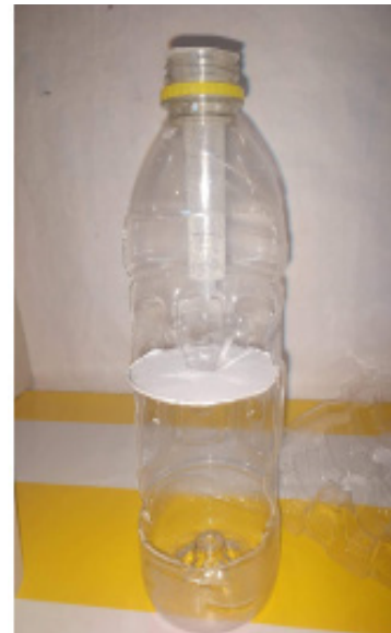
Fig 1. Dispositivo diseñado para realizar la cromatografía por columna
