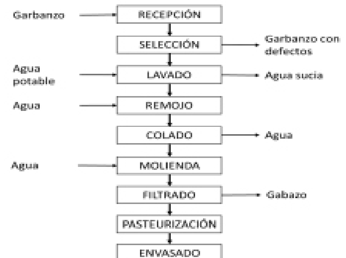
Fig. 1. Diagrama de proceso propuesto para la elaboración de una bebida vegetal de garbanzo
