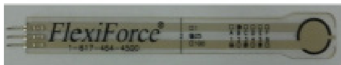
Fig. 9. El modelo A201-25 tiene un rango de sensibilidad de 0 a 25 lb y viene con cuatro diferentes longitudes. Por disponibilidad del proveedor para este trabajo se utilizó un sensor FlexiForce con longitud de 102 mm.
