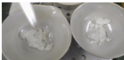
Figura 2. Diatomita sinterizada con una capa de \text{TiO}_2 para la ruta 1 (izquierda) y para la ruta 2 (derecha).
