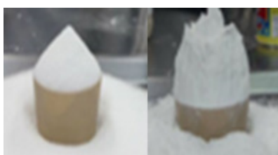
Medición del ángulo de reposo de polvos como un indicativo de sus propiedades de fluidez. Izquierda: Polvo con buena fluidez (azúcar). Derecha: Polvo con mala fluidez (harina de trigo)
