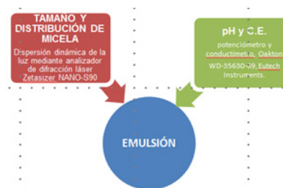
Figura 1. Parámetro de evaluados en las emulsiones elaboradas con 1:2 w/w (Aceite-Pared) a 11000, 15500 y 20000 rpm, por 15min. Por técnica de rotor-estator
