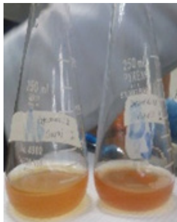
Foto 2. Determinación de Cloruros, basándonos en una titulación por precipitación con Nitrato de plata.
