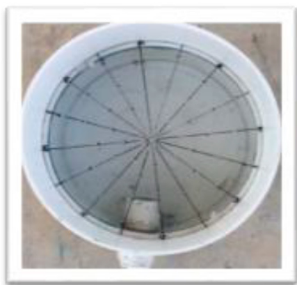
Figura 2. Sistema de alimentación (Placa de acrílico perforada).
