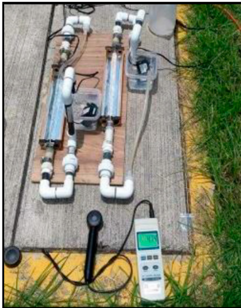
Figura 2. Reactor fotocatalítico solar tipo CPC.
