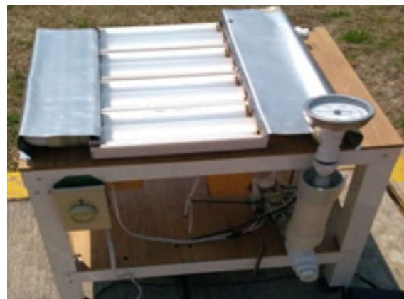
Figura 1. Reactor solar tipo CPC
